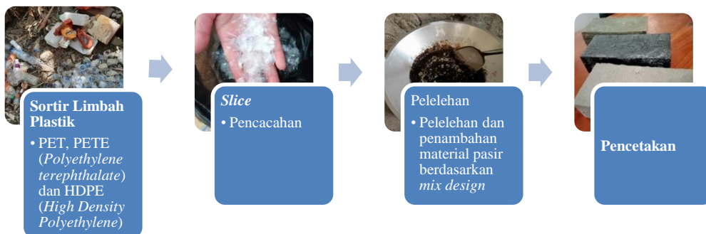
Gambar 8. Alur dan mekanisme paving block zero cement
