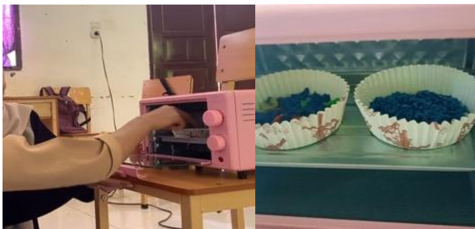
Gambar 2. Proses Melelehkan Plastik HDPE di Oven
